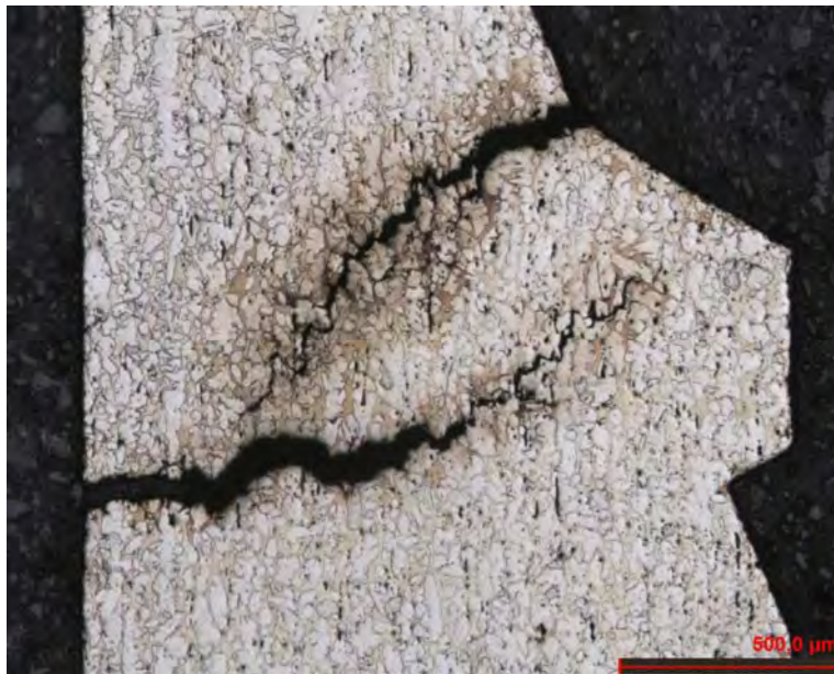
Anodische Spannungsrissskorrosion an einem Fitting aus CuZn39Pb3
