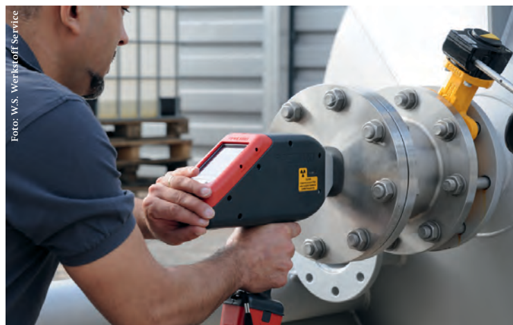
Prüfeinsatz mit einem mobilen Röntgenfluoreszenz-Analysegerät zur Bestimmung der Materialzusammensetzung
